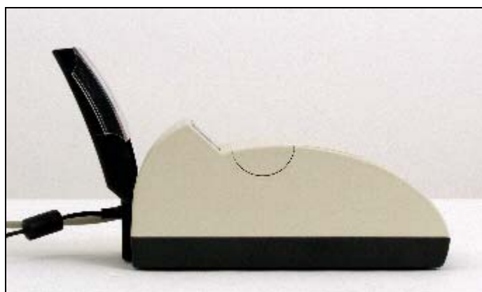
Figura 2. Detalhe da tampa de registo e da bandeja de saída
