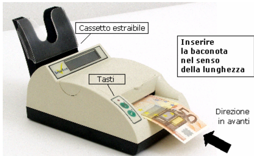
Figura 2 - Modalità di inserimento delle banconote
